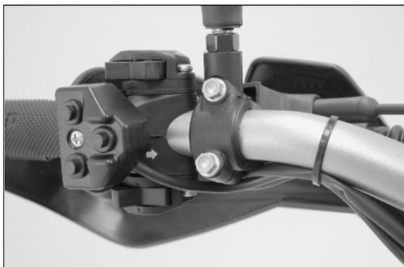
Schrauben festziehen und Kabelstrang parallel zum Lichtschalter-Kabelstrang unter die Scheinwerfermaske verlegen.
