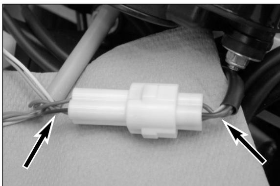
Nehmen Sie dazu die Scheinwerfermaske ab und durchtrennen sie das schwarze Kabel des Tachokabelstranges oder das schwarz/braune Kabel des Fahrzeug-Kabelstranges. Isolieren Sie beide Enden mit Isolierband und montieren Sie die Scheinwerfermaske wieder. Sie können den Originalzustand wieder herstellen, indem Sie das Kabel wieder verbinden.
