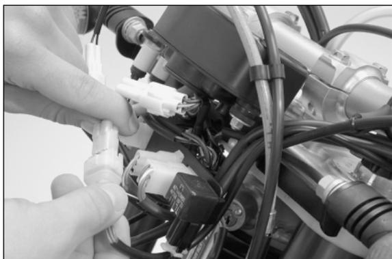
Tachometer montieren und Tripmaster-Schalter anschließen. Scheinwerfermaske montieren.
