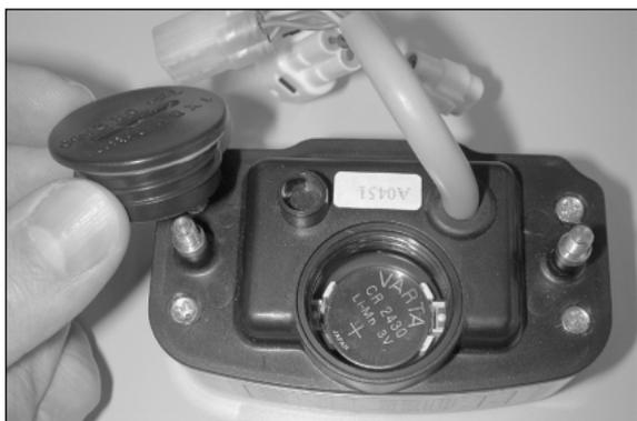
Scheinwerfermaske abnehmen und elektronischen Tacho ausbauen. Verschraubung ❷ entfernen, mitgelieferte Batterie (Typ Duracell CR 2430) mit Schrift nach oben einlegen und Verschraubung montieren.
